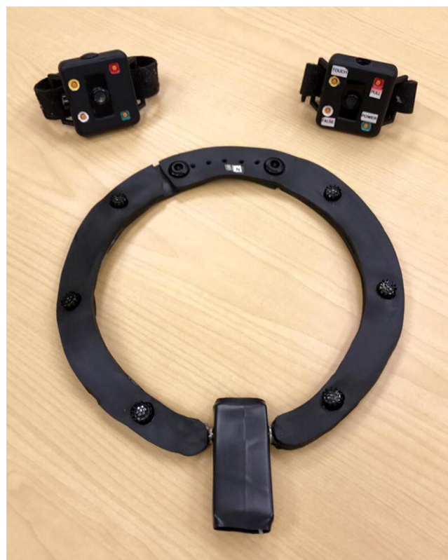
Figura 5 Dispositivo AEMD. Unidad de cuello y pulseras para la muñeca 11 .
